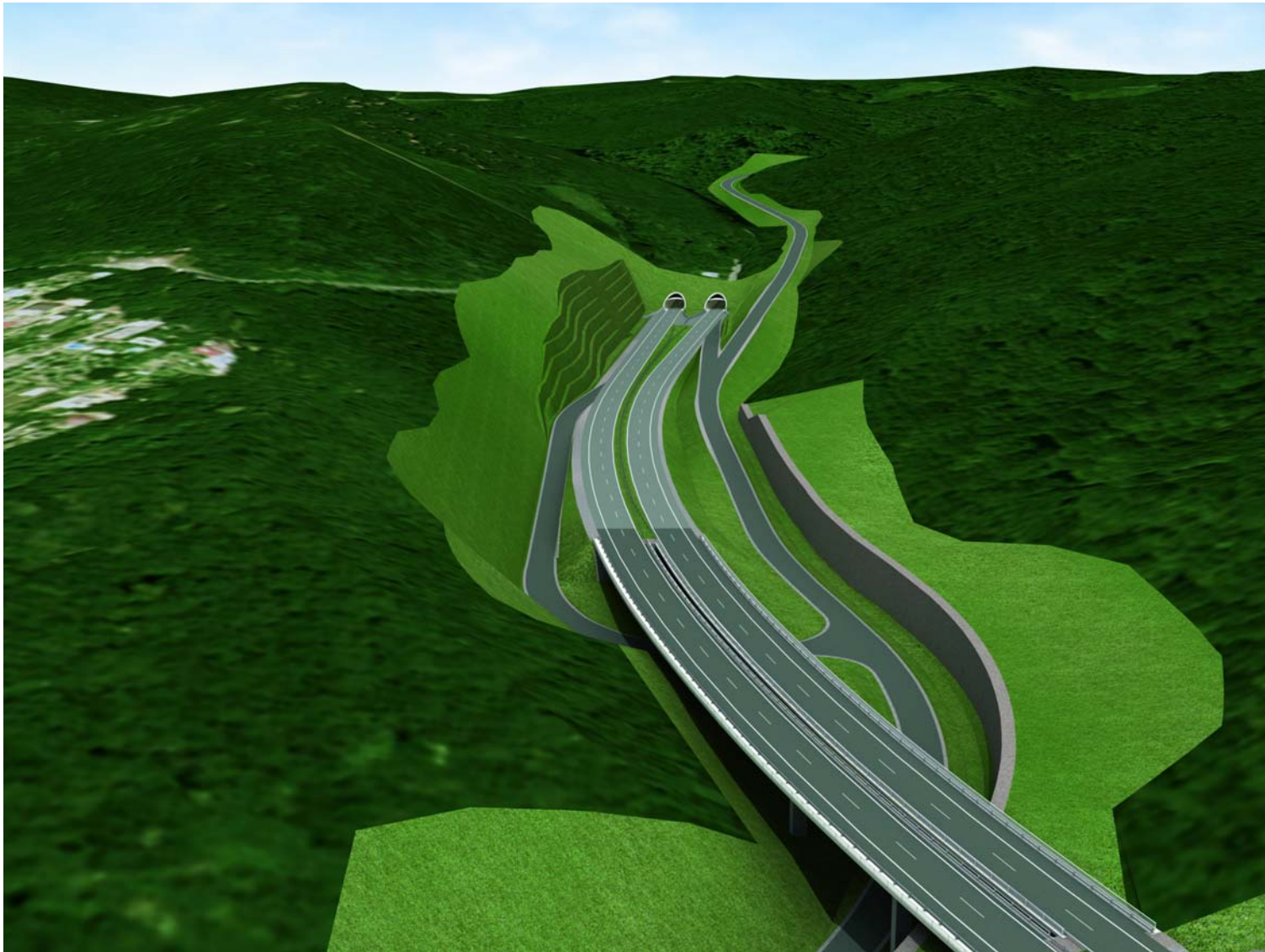
Obr. 7: Variant 3 – portál prvého tunela u Rači
